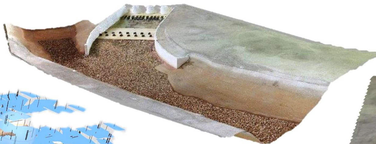
Reconstitución fotogramétrica con software Metashape para levantamiento de modelo 3D
